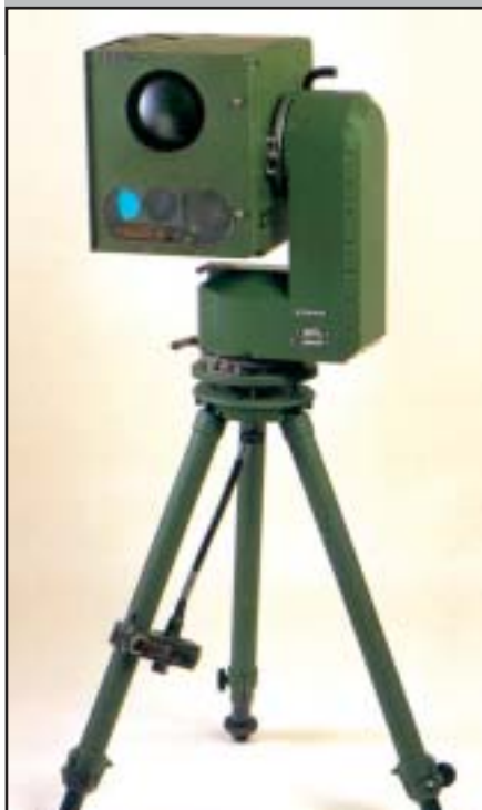
Senzorovou jednotku s termovizí, TV kamerou a laserovým dálkoměrem lze na třínohém podstavci umístit až na vzdálenost 40 m od vozidla.
