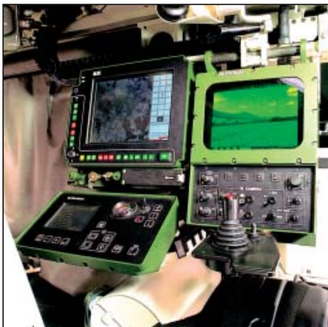
Na snímku z uvnitřku vozidla je na pravé straně vidět displej s obrazem ze senzorové jednotky. Vlevo je obrazovka navigačního systému, na kterou se promítá digitalizovaná mapa se symbolem polohy vlastního vozidla, cílů a také vybrané údaje o situaci na bojišti.
