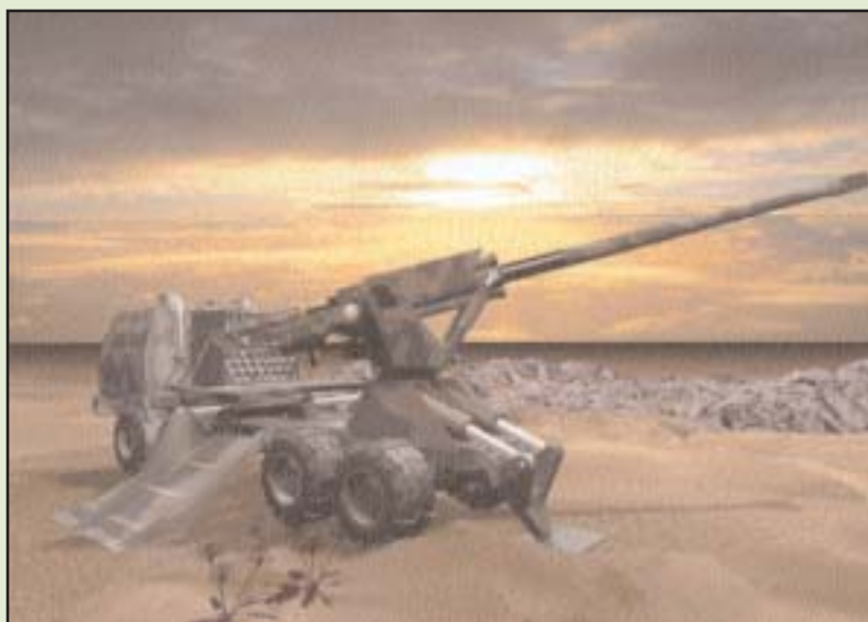
G-6 - Koncem 80. let začaly jihoafrické ozbrojené síly dostávat výkonnou samohybnou kanonovou houfnici ráže 155 mm na kolovém podvozku 6 x 6 vyvinutou a vyráběnou místní
