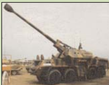
155 mm ShKH vzor 2000 ZUZANA - Na přelomu 80. a 90. let se v Československu pracovalo na vylepšení typu DANA jak z hlediska dostřelu, tak i rychlosti a přesnosti palby. Projekt nesl název ONDAVA a vyznačoval se kanonovou houfnicí s hlavní dlouhou 47 ráží, která měla se standardní
