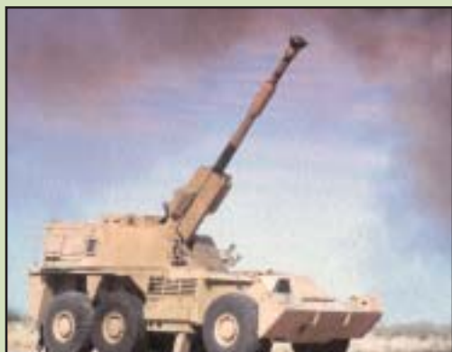
G-6 - Koncem 80. let začaly jihoafrické ozbrojené síly dostávat výkonnou samohybnou kanonovou houfnici ráže 155 mm na kolovém podvozku 6 x 6 vyvinutou a vyráběnou místní
