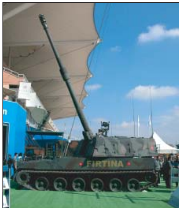
Nová turecká 155mm samohybná kanonová houfnice FIRTINA má hlaveň dlouhou 52 ráží. Při použití nových typů munice má dostřel více než 40 km.
