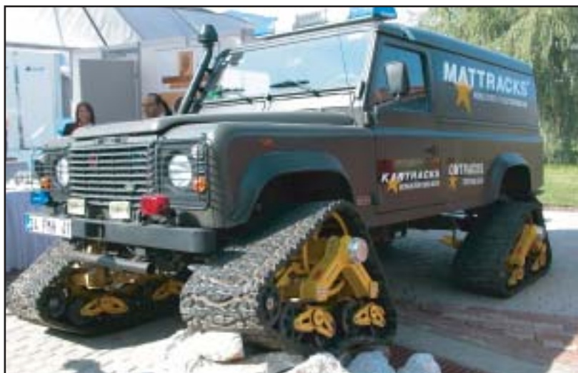
Americká firma MatTracks vyrábí přídatné pásové odpružené podvozky, které lze instalovat na řadu terénních a užitkových vozidel s náhonem na všechna kola. Jedním z nich je i známý Land Rover DEFENDER, který s touto úpravou získá oproti běžnému „kolovému“ provedení výrazně lepší průchodivost těžkým terémem, o sněhu nebo málo únosném podloží ani nemluvě.
