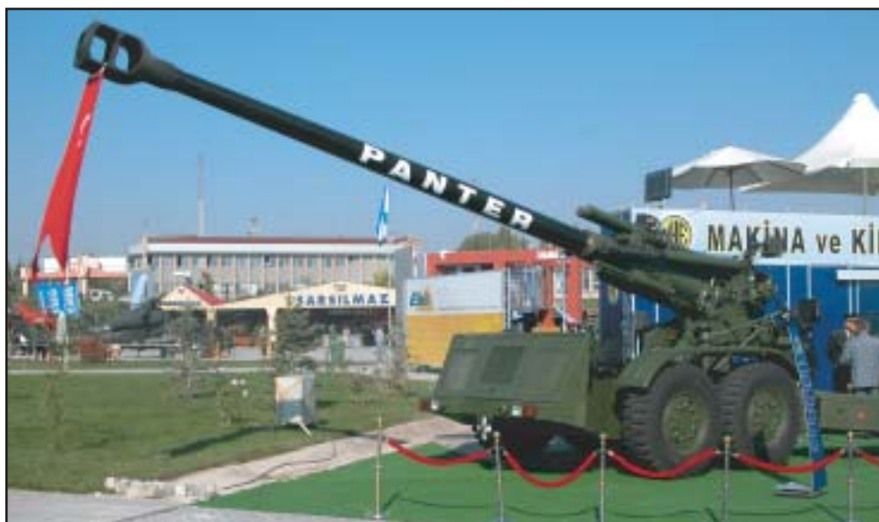
Tažená kanonová houfnice PANTHER se díky pomocné pohonné jednotce může sama přemísťovat na kratší vzdálenosti a stejně jako samohybný typ FIRTINA má maximální dostřel více než 40 km.
