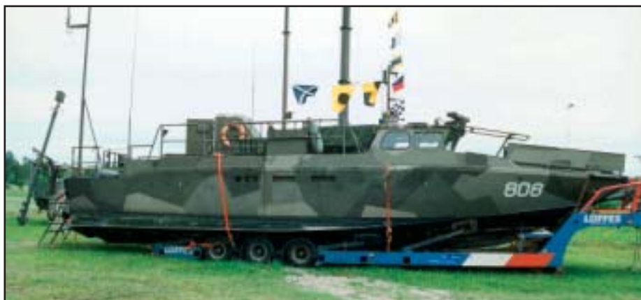
Člun lze rychle přemísťovat po běžných komunikacích na podvozníku.
