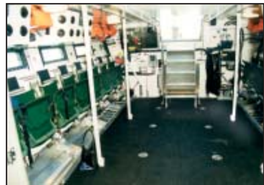
Kabina ve střední části člunu pro přepravu 20 plně vyzbrojených vojáků. Schůdky umožňují výstup na záď.
