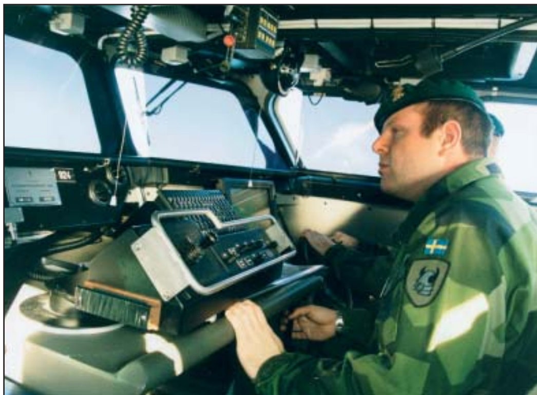
V řídicí kabině mezi řidičem a velitelem/navigátorem je prostor pro velitele dvou desítek vojáků přepravovaných v hlavním prostoru. Takže člun může pojmout až 21členný výsadek.
